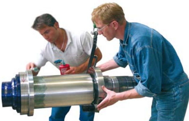
EcoRolls超强硬质合金组合轧辊装配中
