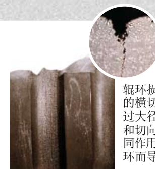
断裂的碳化钨辊环
