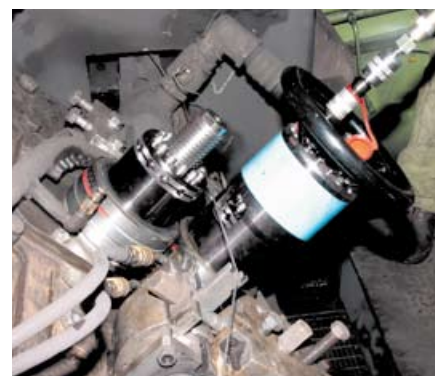
液压拉伸锁紧过程中的 A-LOC
